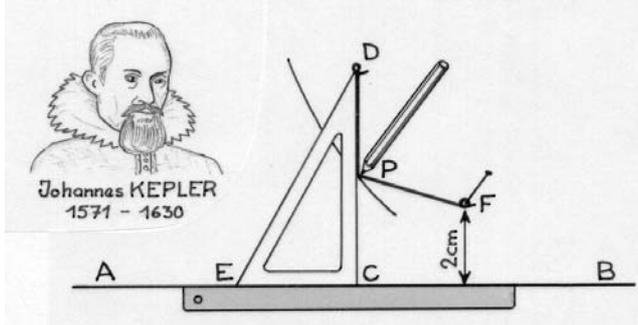
Se si fa scivolare il lato EC della squadra sulla retta (AB), il punto P descrive allora una parabola.
