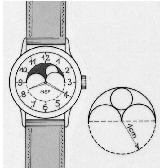
la luna è rappresentata da un disco. Questo è disegnato su una lamina circolare scura che ruota attorno allo stesso asse delle lancette e che si scorge in un'apertura delimitata da 3 semicerchi. Il diametro della luna è il massimo possibile perché la si veda interamente nell'apertura,
